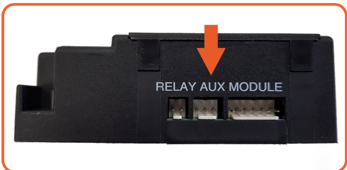
Illustration A.11 - Position AUX du récepteur
