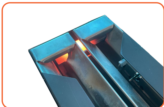
Afb. 4.5 PRIMING: brandstof wordt ontstoken
