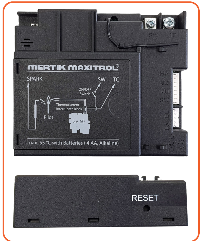
Abbildung 4.2: Empfangsgerät (Drauf- und Seitenansicht)
