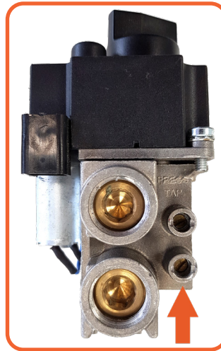
Abbildung A.4 - Messstelle A
