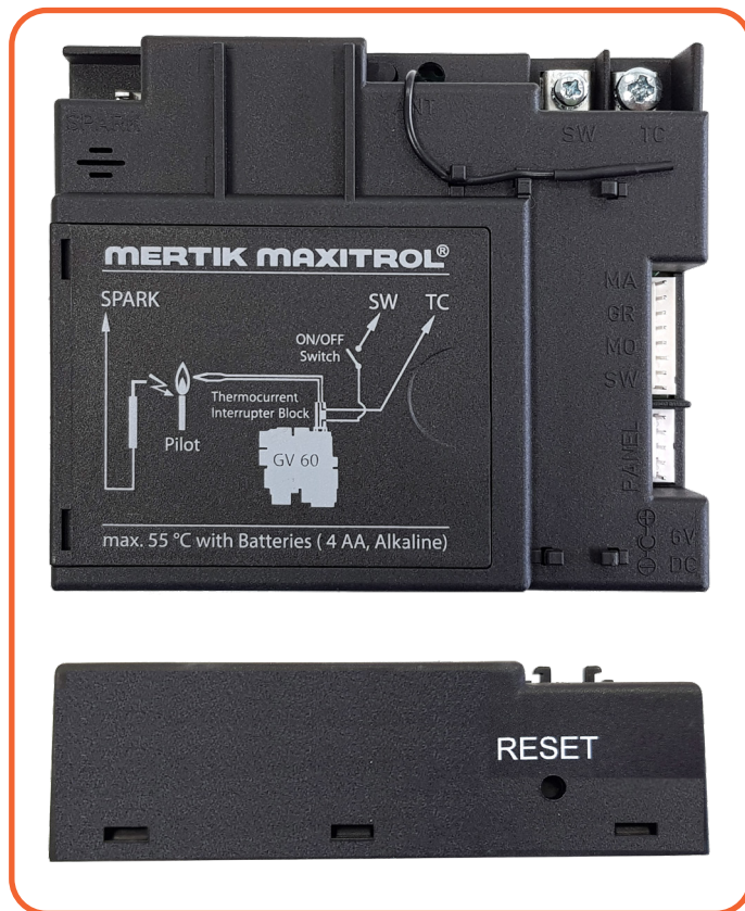
Abb. 4.2: Empfangsgerät (Drauf- und Seitenansicht)
