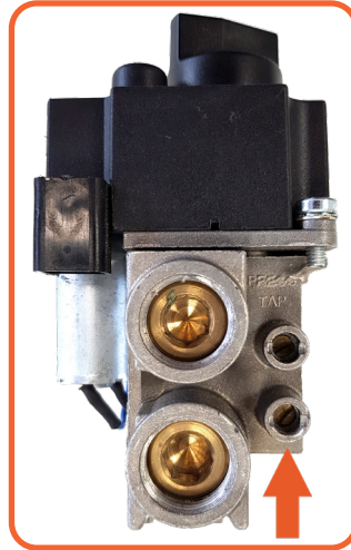
Abbildung A.4 - Messstelle A
