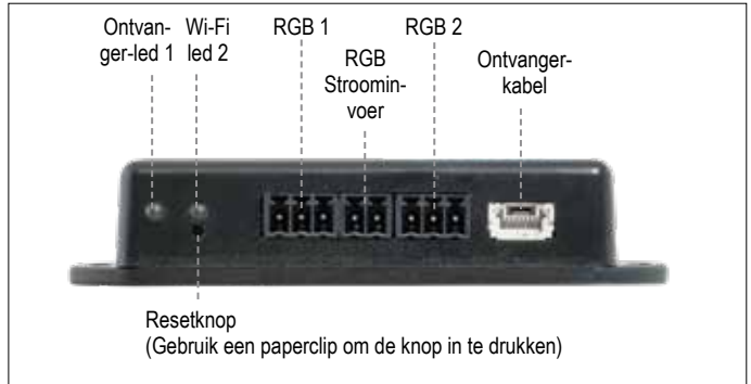
Afbeelding 4: Wi-Fi Box (B6R-W2...)
