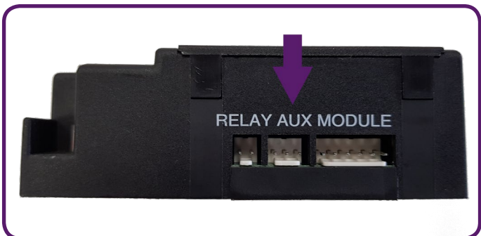
Illustration A.11 - Position AUX du récepteur
